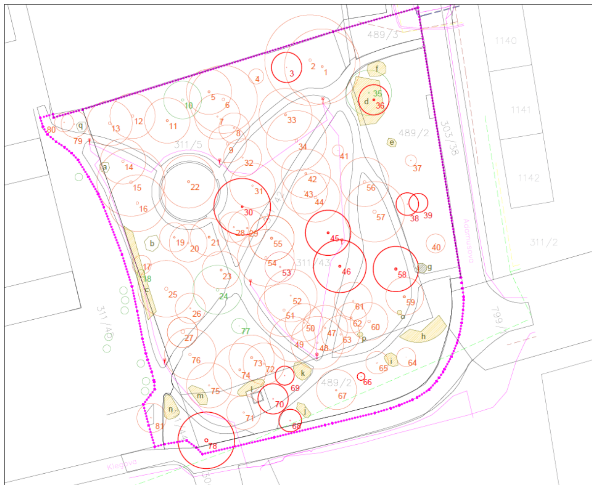
Obr. 2: Plán aktivit při revitalizaci parku. Kácené stromy jsou označeny silně červeně, ořezy oranžově a bez zásahu zeleně, keře se zásahem žlutě.
